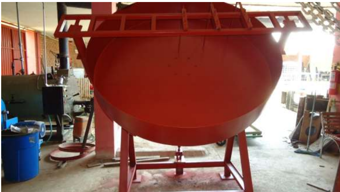
DISCO GRANULADOR DE 5.5 KW PRODUCCION DE 1.5 A 2.0 TN/Hra fabricado por www.industriasvillaverde.com
