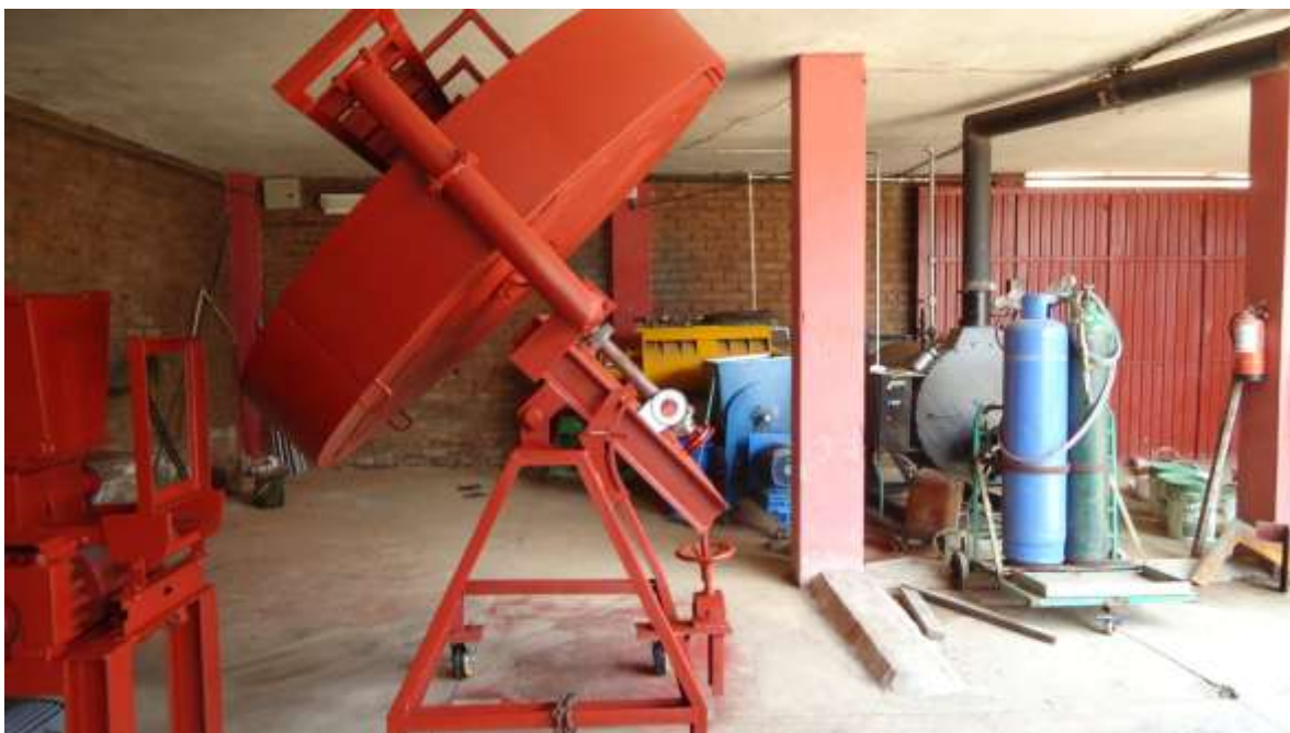
DISCO GRANULADOR DE 5.5 KW PRODUCCION DE 1.5 A 2.0 TN/Hra fabricado por www.industriasvillaverde.com
